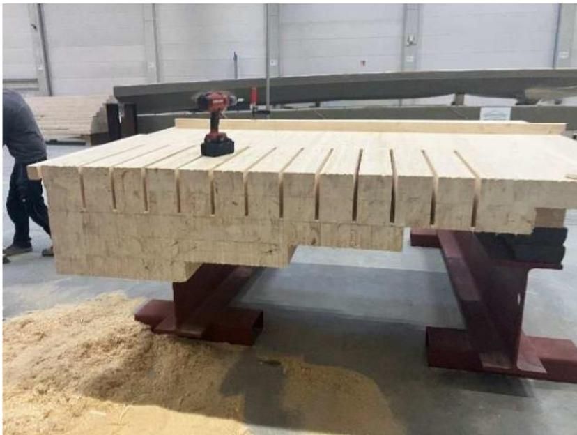
Herstellung der 17 mm Schlitz mit Kettenstemmer Abbundanlage, d.h. ein Arbeitsgang
