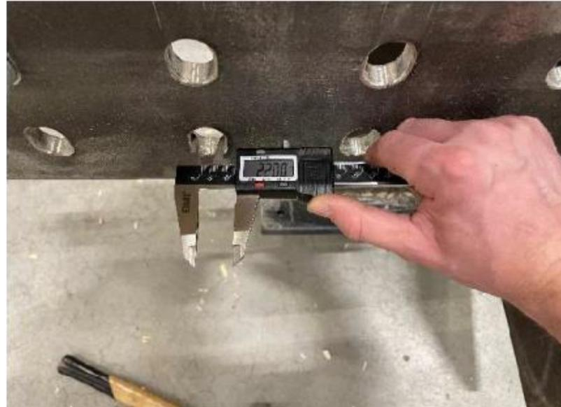
Kontrolle der Bohrlöcher: 22 mm;
