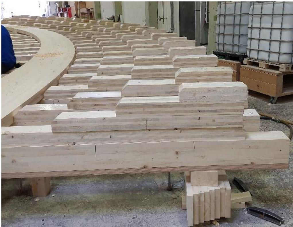
Blockverklebung mit Negativ (oben); Aufbringung Pressdruck Verklebung üblicherweise (nur) an den Rändern mit Spindeln
