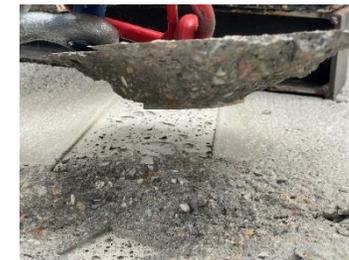
u.a. Auszugsversuche ComBar sowie unter Schrägzugkraft für Transportankersystem PHILIPP Flachstahlanker RD 16x36mm auf Platte 60x60x5mm nichtrostender Stahl in 10 cm dicken Carbonbeton-Decken aus unbewehrtem Beton C 70/85
