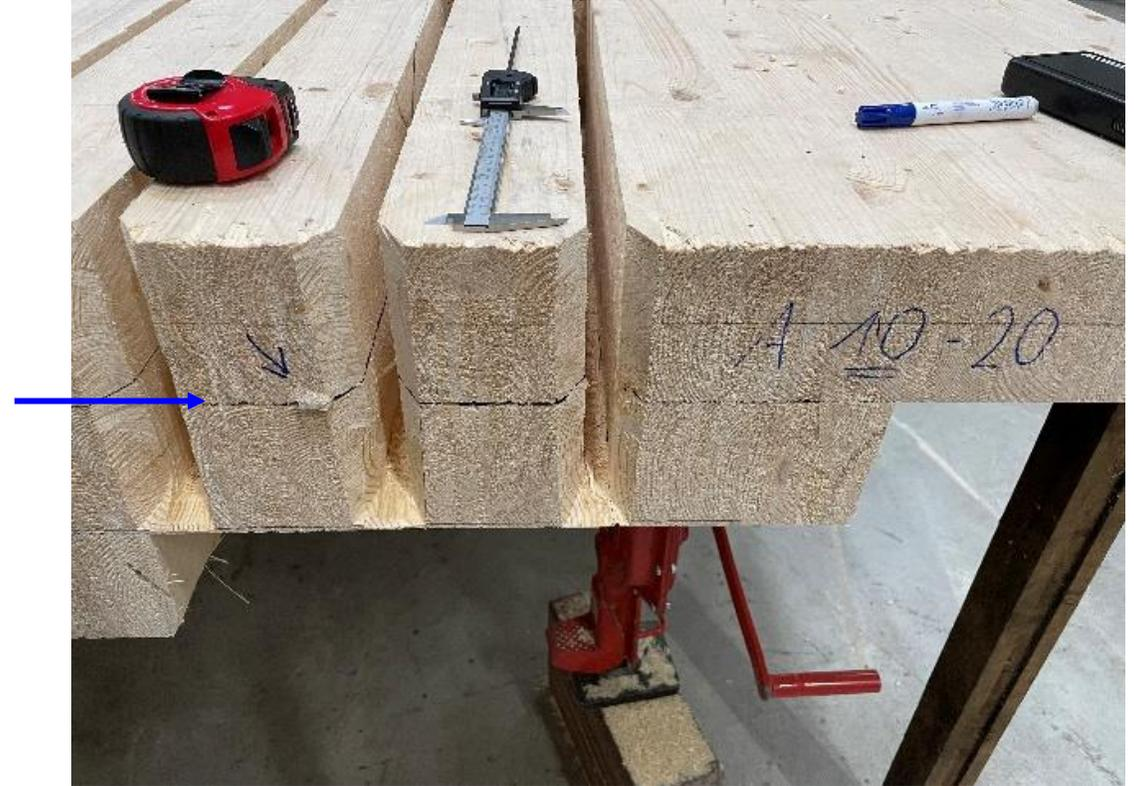
Anschluss Stützenkopf Helix Achsen 10 und 20 nach Einsägen der Schlitze
