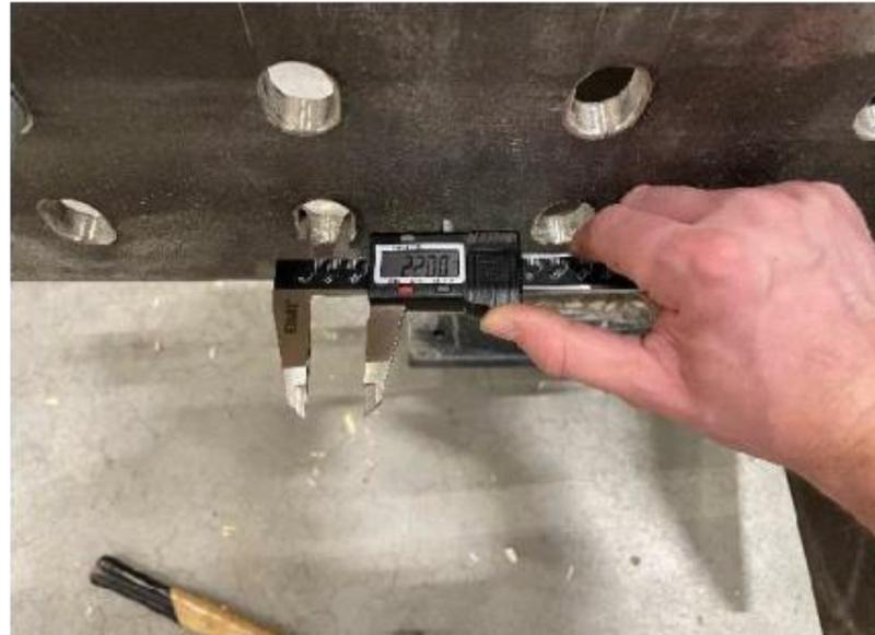
Kontrolle der Bohrlöcher: 22 mm;
