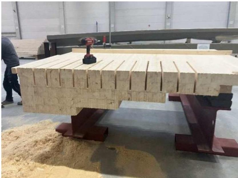
Herstellung der 17 mm Schlitz mit einem Kettenstemmer, der in einem Arbeitsgang genau 17 mm Schlitzbreite ermöglicht.
