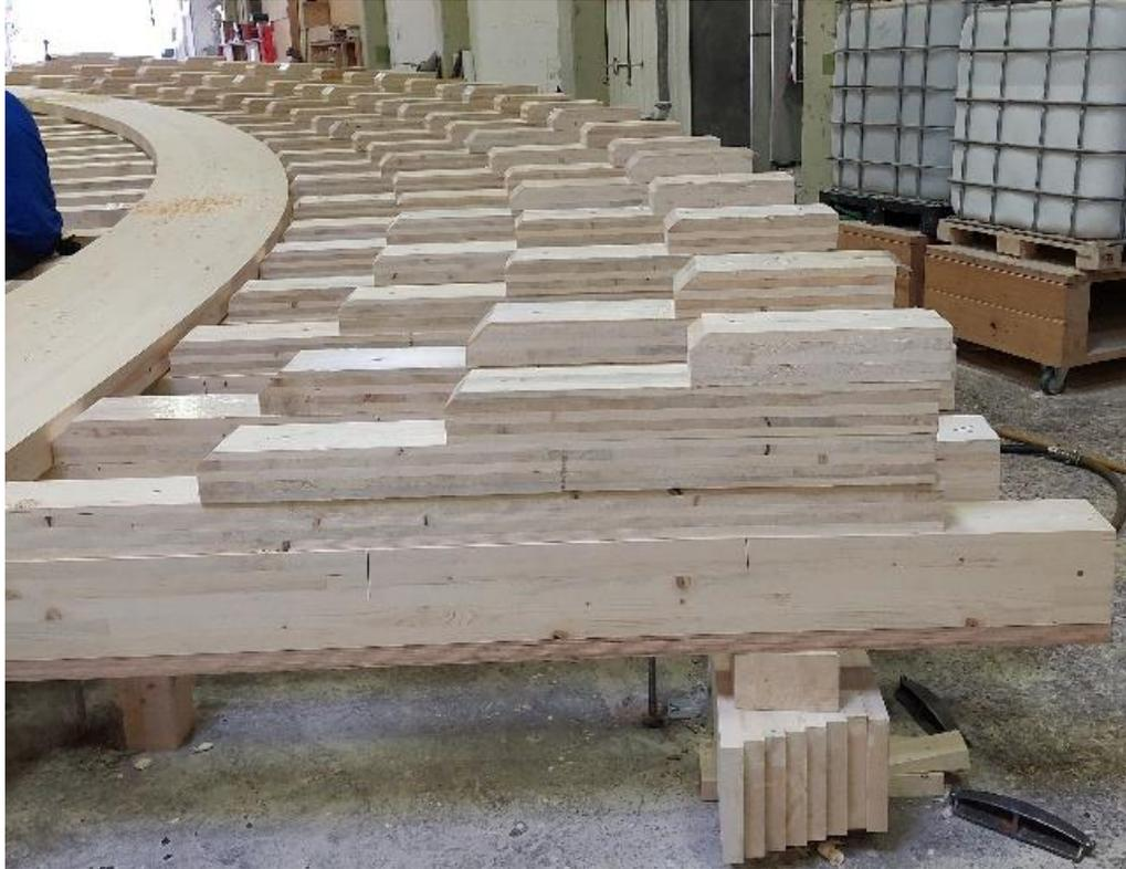
Blockverklebung mit Negativ (oben) und ursprüngliche Aufbringung Pressdruck (nur) an den Rändern (rechts)
